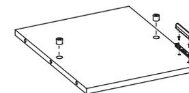
Posicionar os tambores minifix **A** no tampo e base. No tampo, do lado frontal esquerdo, parafusar o Pulsador Magnético **G**.
