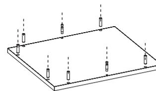
Instalar cavilhas **D** nas laterais do armário, em seguida fixe os pinos minifix autoatarraxante **B**
