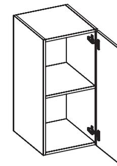
Posicionar a porta paralelamente com a lateral e fixar as dobradiças utilizando os parafusos 4x14 **H**
