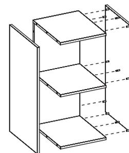
Encaixar as peças nas laterais pré montadas no sentido indicado pela imagem
